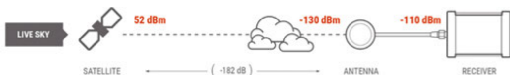
Propagación de la señal GNSS real desde el satélite al receptor GNSS (fuente: Manual de Skydel, 2024 Safran )
