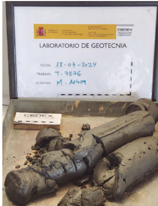
Material extraído de uno de los tubos Shelby recibidos en el Laboratorio de Geotecnia para la realización de ensayos
