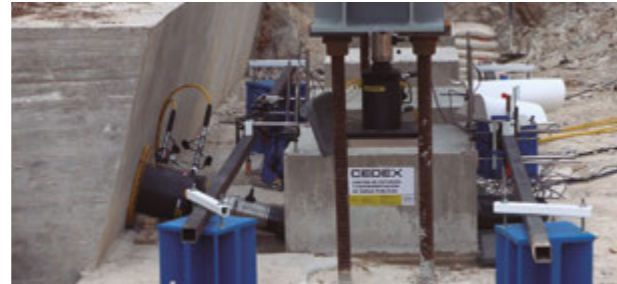
Configuración de un ensayo de corte in situ para uno de los dados. Vista lateral
