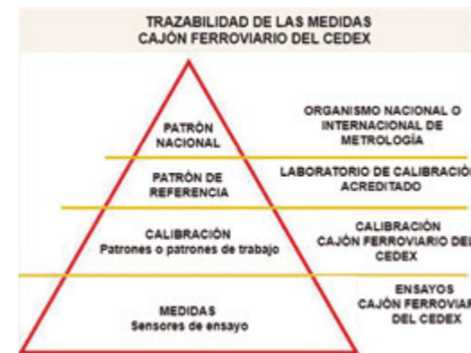
Trazabilidad de las medidas realizadas con los sensores de ensayo del CFC
