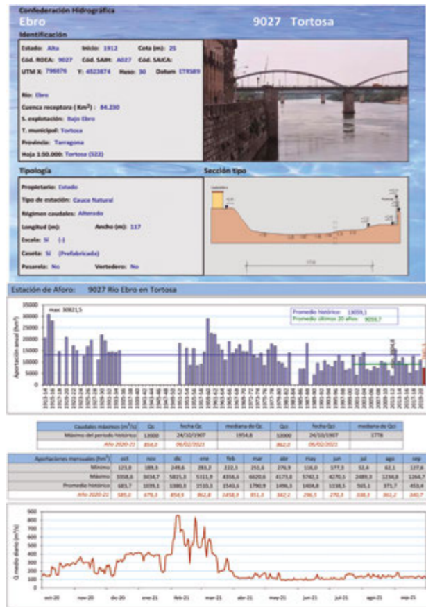
Ejemplo de ficha descriptiva de una estación de aforo en río (río Ebro en Tortosa)
