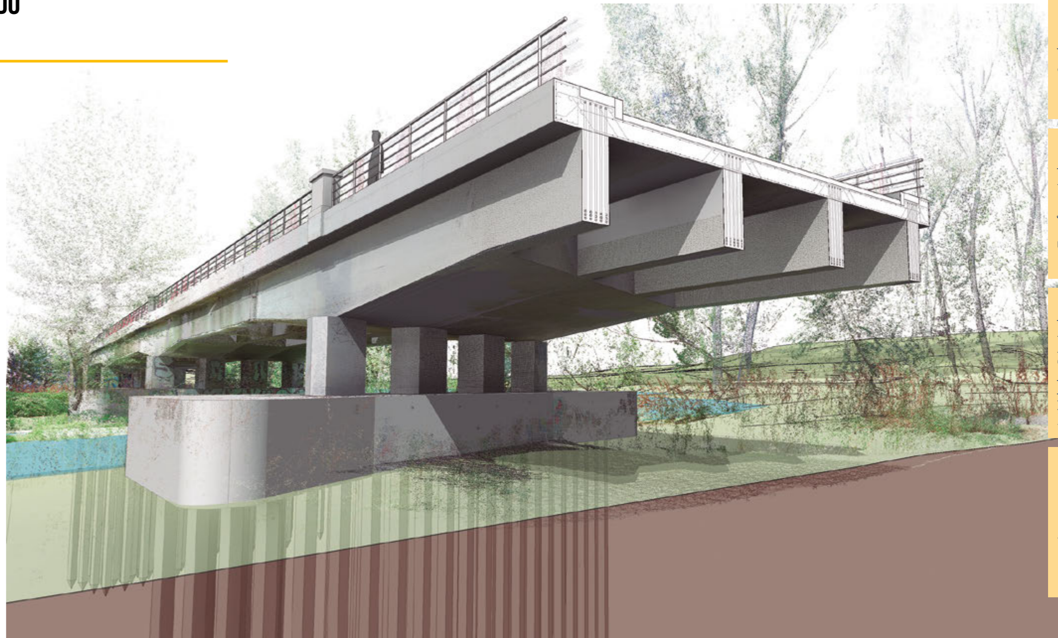
Sección transversal del puente de Villaviciosa de Odón sobre el río Guadarrama construido en 1954 por Carlos Fernández Casado. Vista del modelo BIM levantado a partir de la nube de puntos 3D. Fuente: elaboración propia
