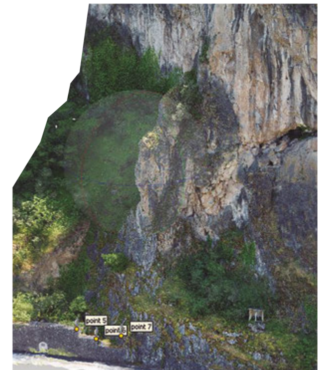
Vista del modelo digital en 3D con puntos de referencia con coordenadas
