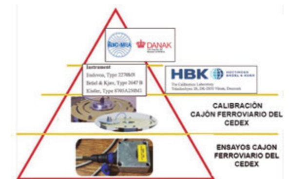
Trazabilidad de las medidas de aceleración del CFC
