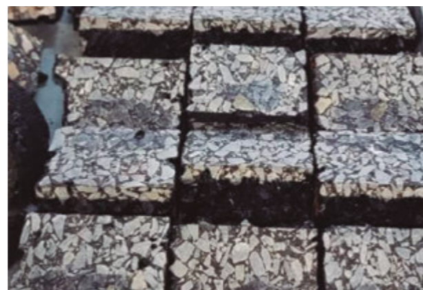
Probetas de mezcla bituminosa fabricadas con RA
