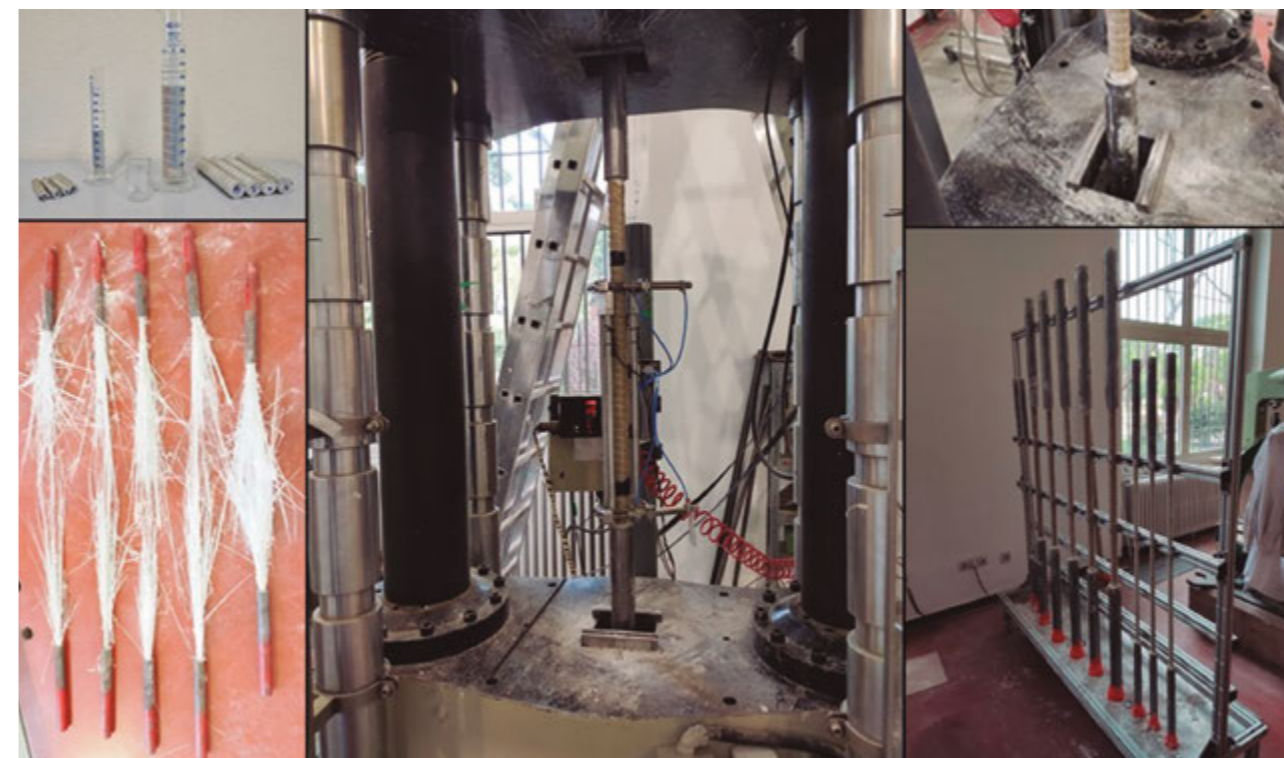
Ensayo de tracción armadura GFRP
