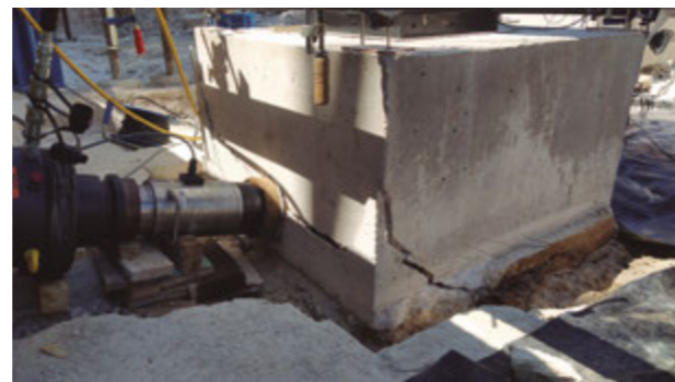
Vista de la rotura de uno de los dados tras la ejecución de un ensayo
