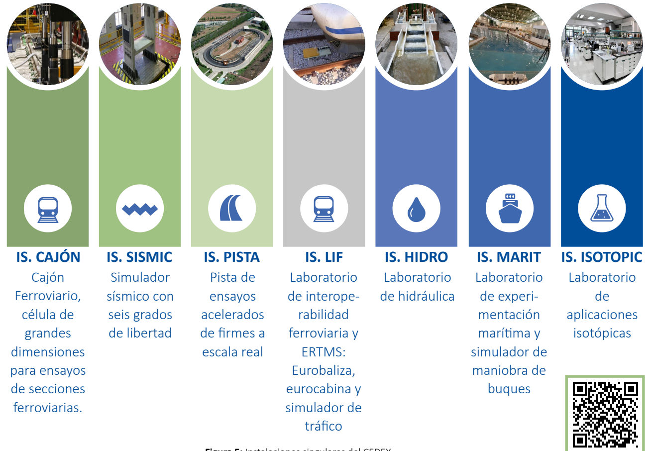
Figura 5: Instalaciones singulares del CEDEX.
