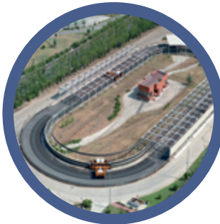
IS. PISTA Pista de ensayos acelerados de firmes a escala real.
