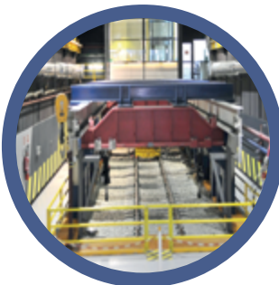
IS. CAJÓN Cajón Ferroviario, célula de grandes dimensiones para ensayos de secciones ferroviarias.
