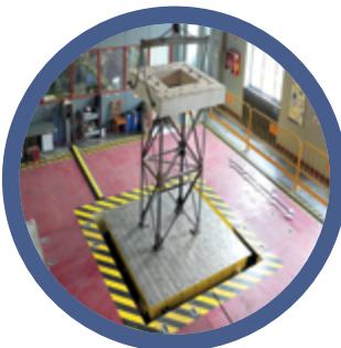
IS. SISMIC Simulador sísmico con seis grados de libertad.
