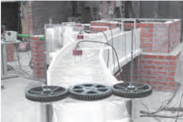
Modelo físico del Canal del Enlace Directo (Huelva).
