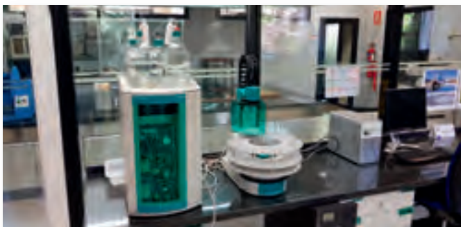
Figura 10. Equipo de cromatografía iónica IC de la sección de Química del Laboratorio de Geotecnia.
