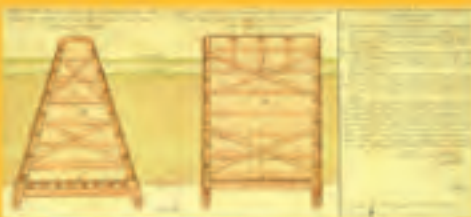
Proyecto de dique artificial. Cajo de defensa relleno de piedras, Boca Grande 1756. Cartagena de Indias. Archivo gráfico CEHOPU.
