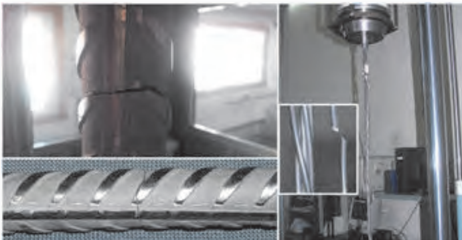
Fracturas en aceros para hormigón.
