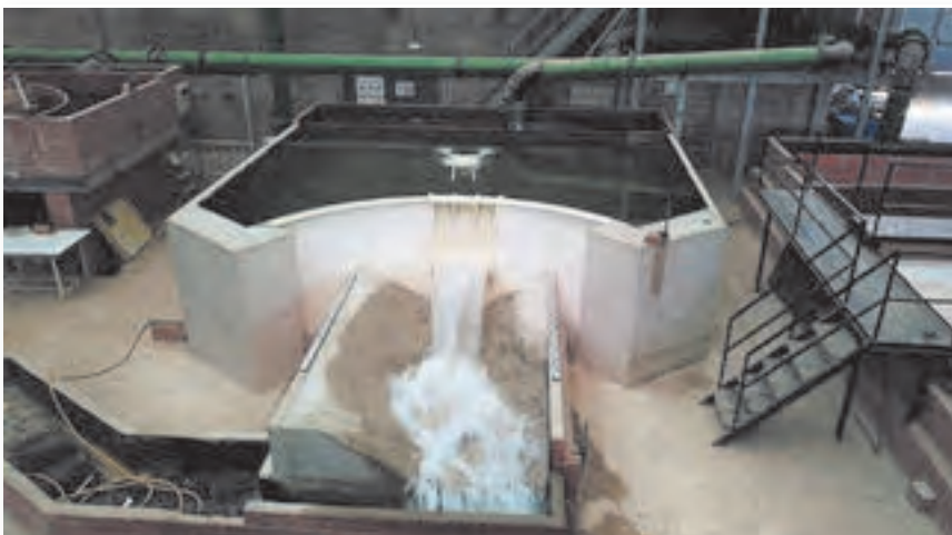
Funcionamiento del equipo dron durante ensayo en modelo físico.
