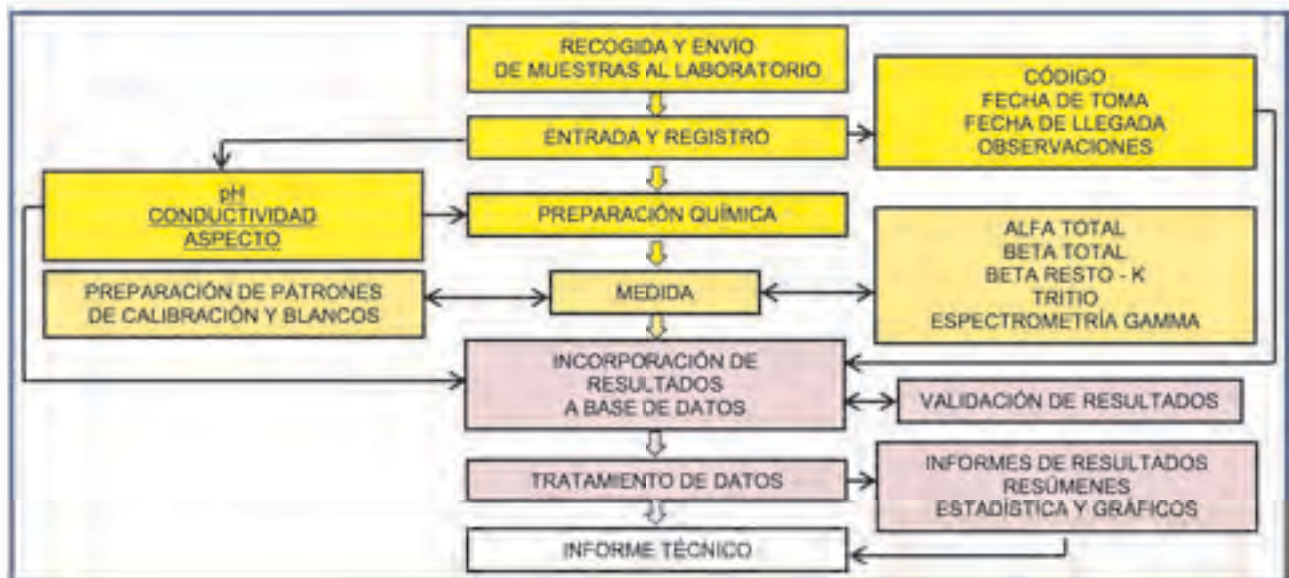
Proceso de tratamiento de muestras, ensayo en laboratorio y elaboración de informes de vigilancia radiológica del medio acuático.
