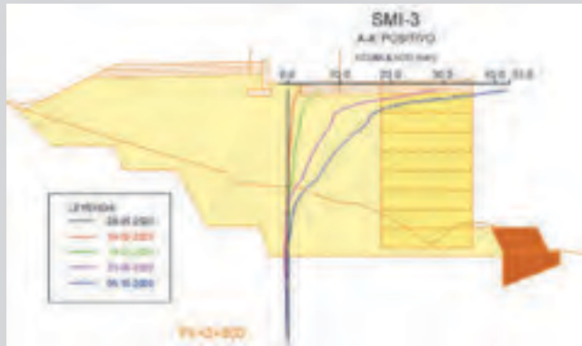
Movimientos horizontales en inclinómetro.
