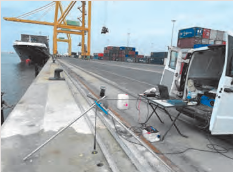
Equipo de medida con la sonda introducida en un sondeo.
