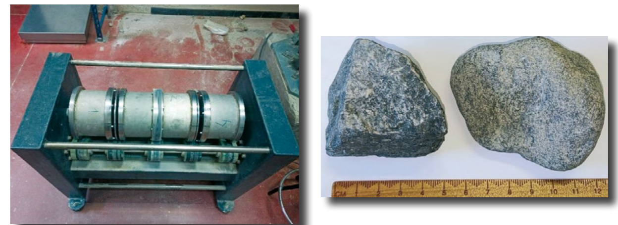
Figura 3. Equipo Micro Deval del LG-CEDEX utilizado para los estudios de degradación del balasto.
