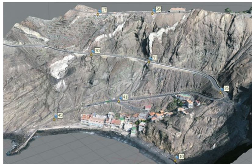
Figura 1. Modelo digital del terreno elaborado a partir de fotogrametría con dron.
