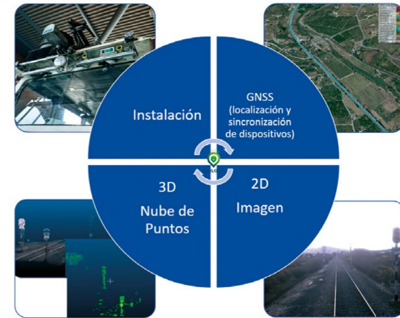
Ejemplo de la información recogida en tiempo real durante la realización de las pruebas en vía.
