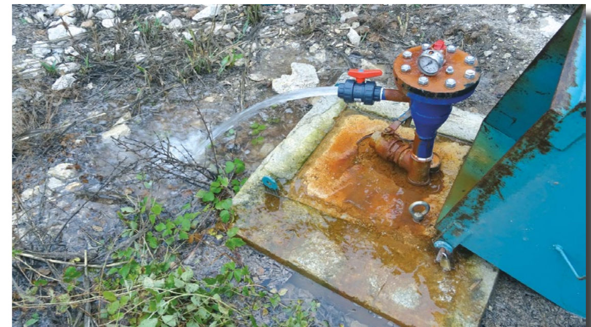
Sondeo surgente acondicionado como piezómetro, punto de registro continuo y punto de muestreo situado en un acuífero localizado aguas abajo del embalse de Bellús.
