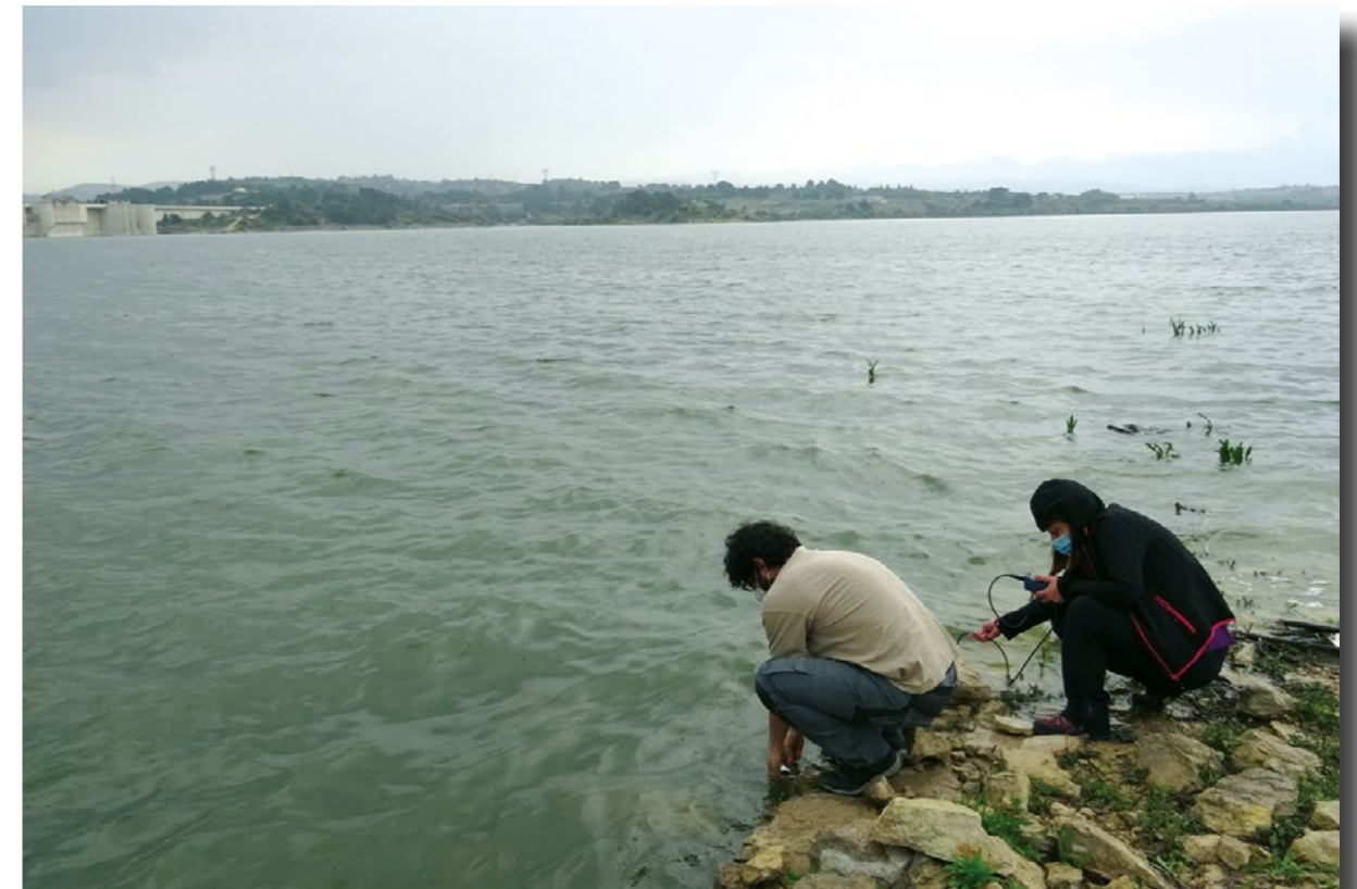
Medida de parámetros inestables en campaña de muestreo del agua para estudio isotópico de estanqueidad del embalse de Bellús.
