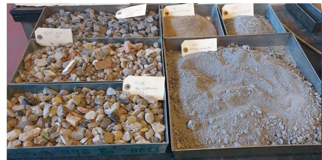
Áridos RCD y escorias de incineración de RSU para fabricación de hormigón.
