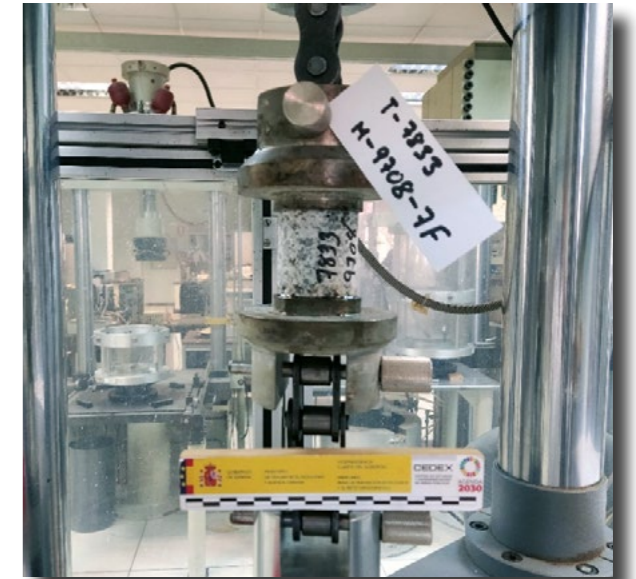
Ensayo de tracción directa sobre una muestra granítica de baja esbeltez.
