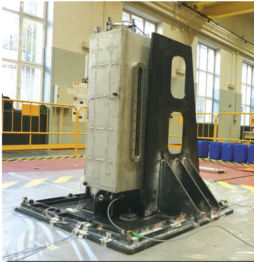
Prototipo de ensayo para prueba de vibración.
