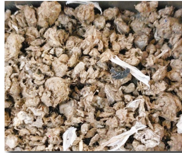
Residuo de celulosa con restos poliméricos empleado en una mezcla SMA.
