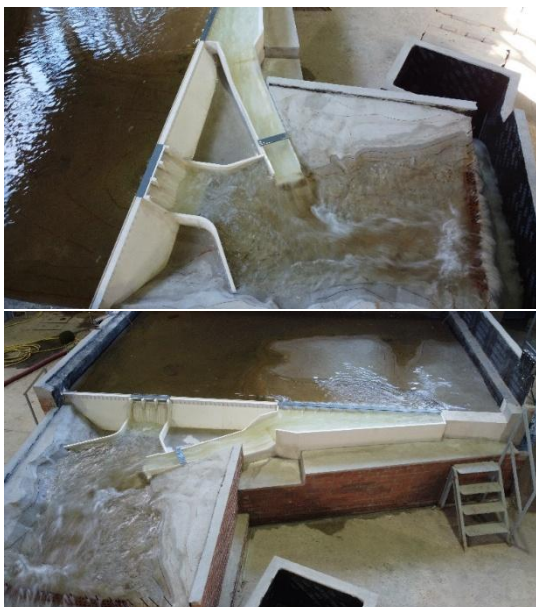
Estudio hidráulico de la presa de Regajo.
