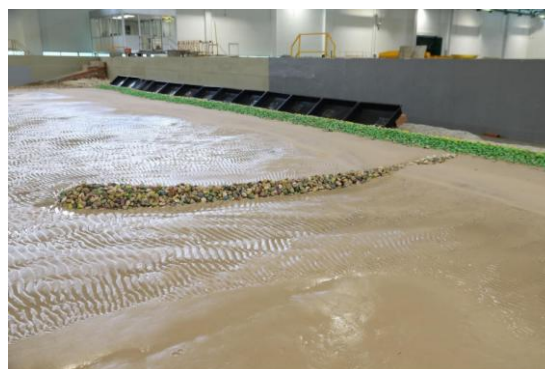
Ensayo 3D en el tanque de oleaje multidireccional para el estudio de la rebasabilidad y estabilidad del dique longitudinal de defensa del FF.CC en el Maresme.
