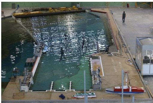
Ensayos 3D de agitación y buques atracados para la futura ampliación de la Dársena de África del Puerto de Las Palmas.
