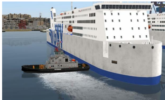
Remolcador empujando de carnero por la amura de estribor a un ferry de 203 m de eslora
