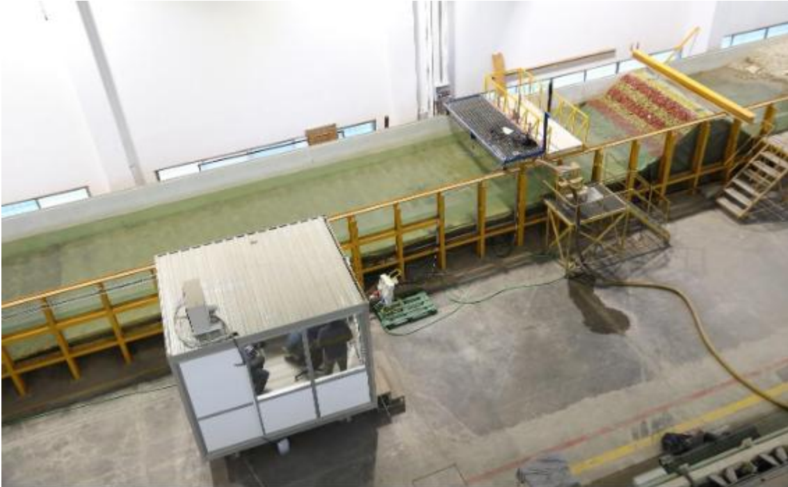
Ensayos 2D de evolución de averías de diques en talud
