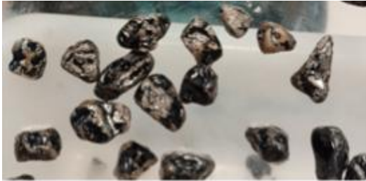
Ensayo de afinidad árido betún
