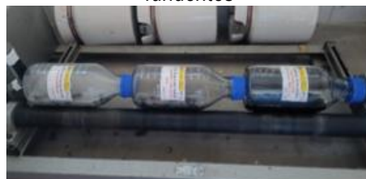
Dispositivos empleados en el análisis de fundentes
