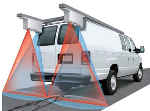
Sistema de imágenes 3D con iluminación láser.
