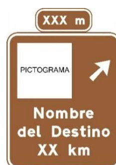
Cartel de preseñalización en carretera convencional
