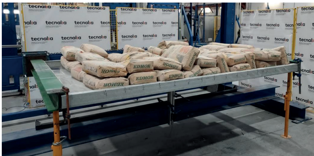
Figura 3: Imagen de un ensayo para la determinación del valor de la carga de viento de diseño y de la deformación estática y permanente.
