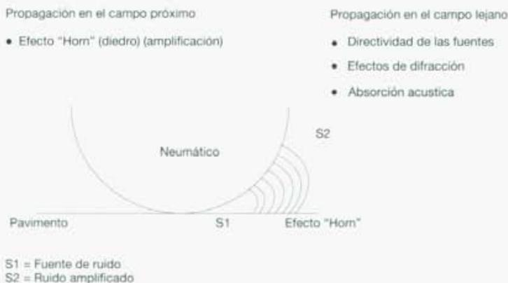
trompeta o diedro), y por otros mecanismos indicados en la figura 5.3. Rápidamente es percibido de forma atenuada por los receptores situados alrededor de la carretera.
