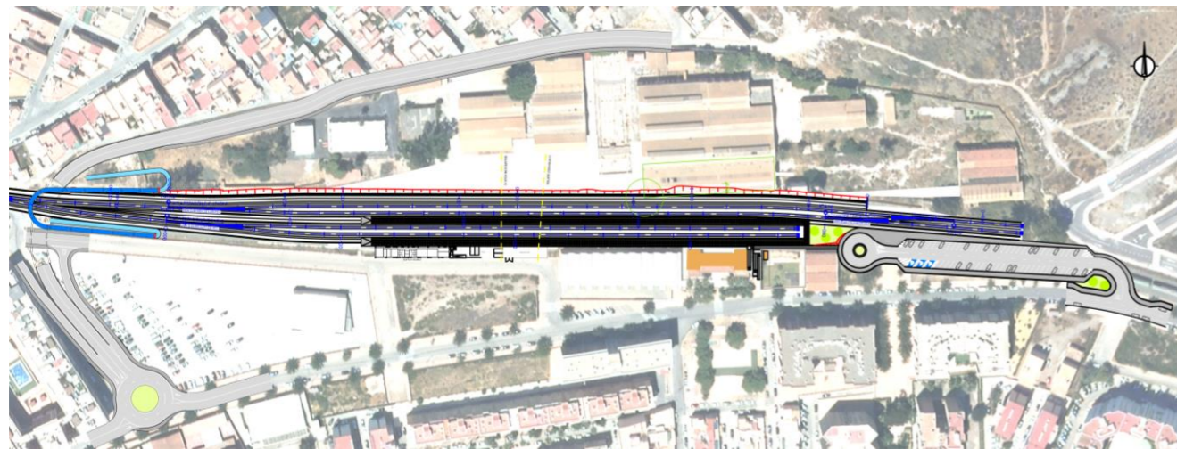
Figura 7. Trazado de las vías en la estación de Águilas en la Alternativa A en una vista aérea de la ciudad.
