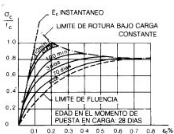
RELACIÓN ENTRE LA TENSIÓN DEL HORMIGÓN Y LA TENSIÓN DE ROTURA POR COMPRESIÓN EN PROBETAS CILÍNDRICAS
