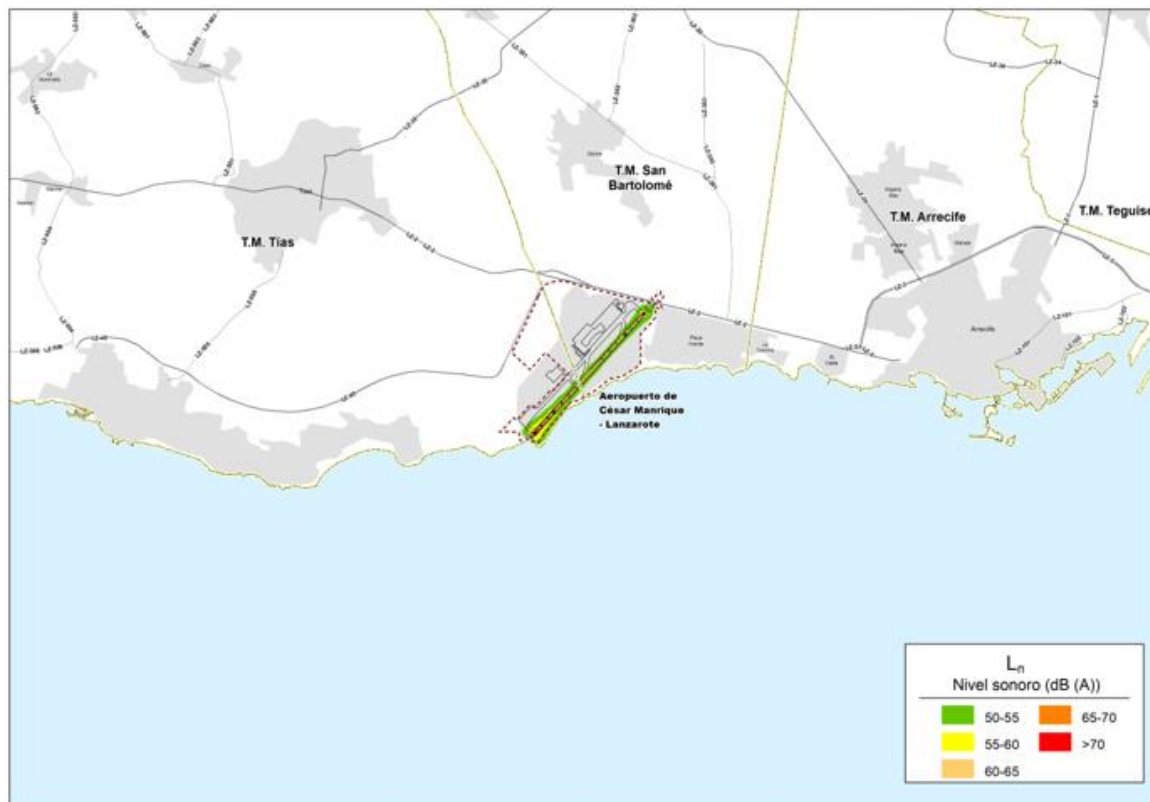
Ilustración 3 Mapa de niveles sonoros Ln. MER Fase IV. Aeropuerto César Manrique Lanzarote
