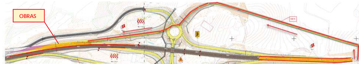
Plano 2.12.3 Soluciones propuestas al tráfico durante la ejecución de las obras. Planta general (fase 3). HOJAS 1 Y 2
