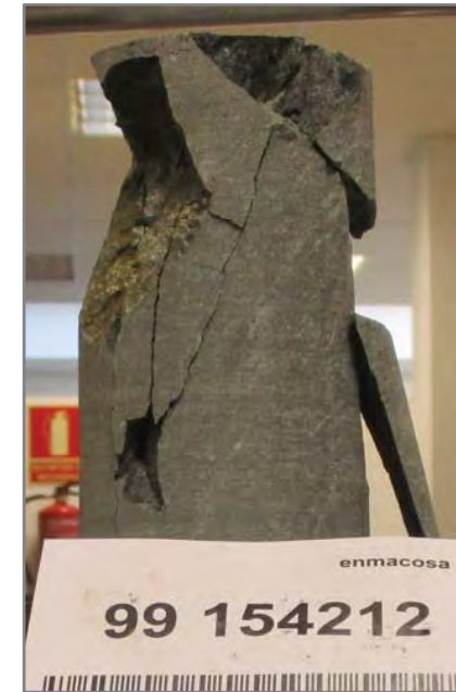
Foto N°1 Vista del testigo después de la rotura
