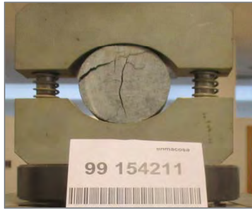
Foto N°2 Vista del testigo después de la rotura
