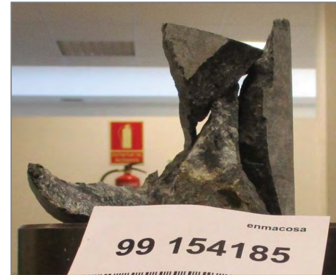
Foto N°1 Vista del testigo después de la rotura
