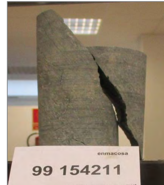
Foto Nº1 Vista del testigo después de la rotura
