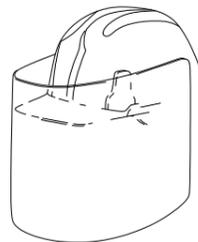
CASCO DE SEGURIDAD con pantalla antiproyecciones
