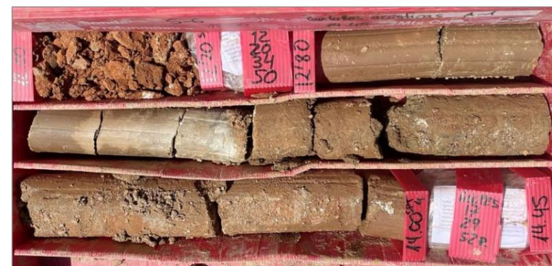
Figura 11. Detalle de la unidad litológica de Depósitos aluviales en el sondeo S-6.
