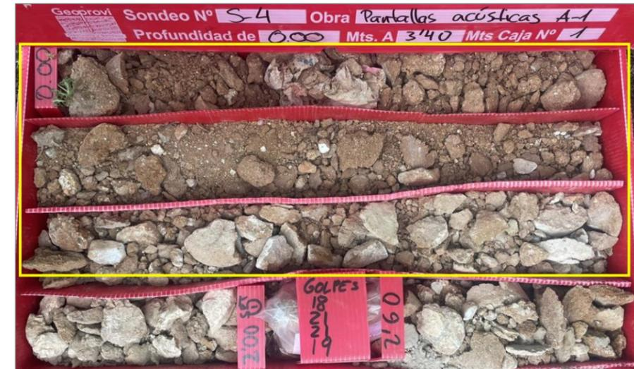
Figura 13. Detalle de la unidad litológica de Rellenos antrópicos de vertido en el sondeo S-4.
