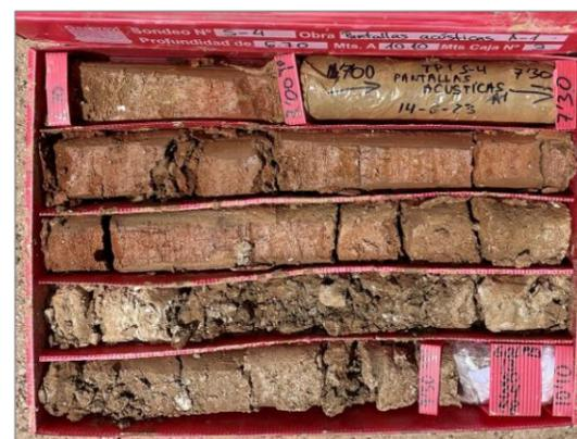
Figura 10. Detalle de los materiales más cohesivos de la unidad litológica de Arenas Arcósicas en el sondeo S-4.
