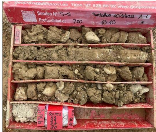
Figura 8. Detalle de materiales granulares gruesos de la unidad litológica de Arenas Arcósicas en el sondeo S-5.
