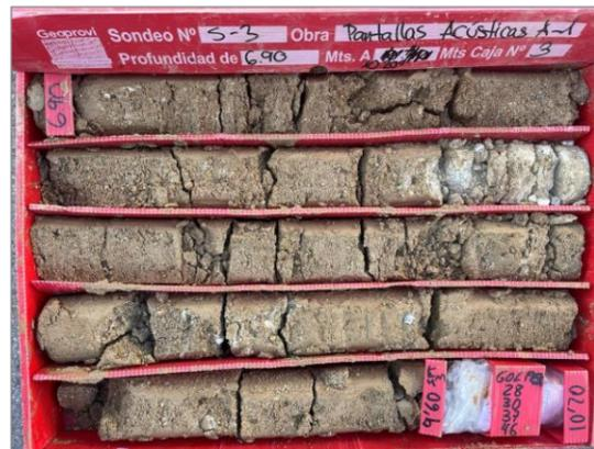
Figura 9. Detalle de materiales granulares finos de la unidad litológica de Arenas Arcósicas en el sondeo S-3.
