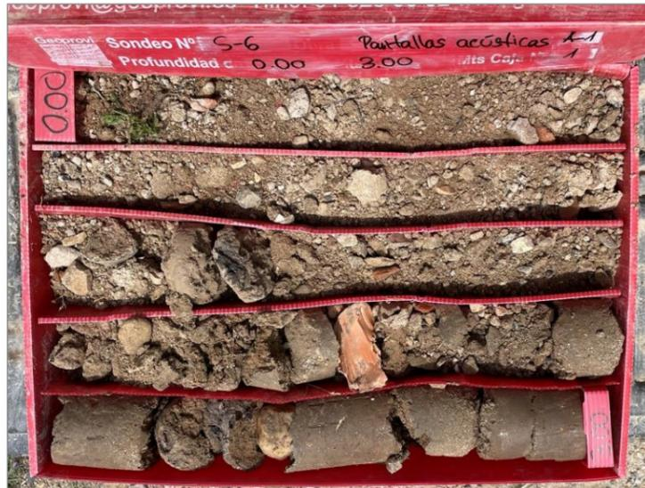
Figura 12. Detalle de la unidad litológica de Rellenos antrópicos compactos S-6.
