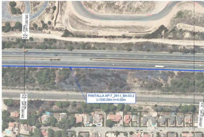
Figura 14. Posición de la pantalla con el terreno circundante.
