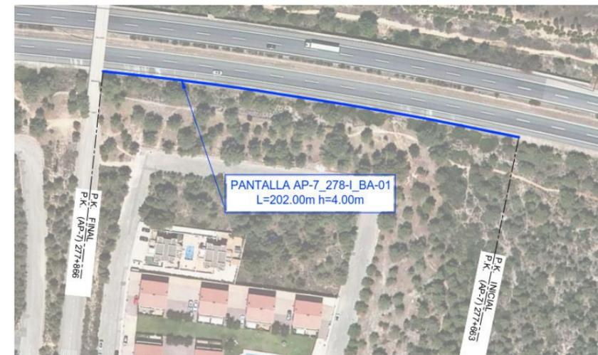
Figura 6. Posición de la pantalla con el terreno circundante.
