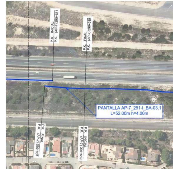
Figura 13. Posición de la pantalla con el terreno circundante.
