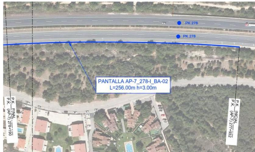
Figura 7. Posición de la pantalla con el terreno circundante.
