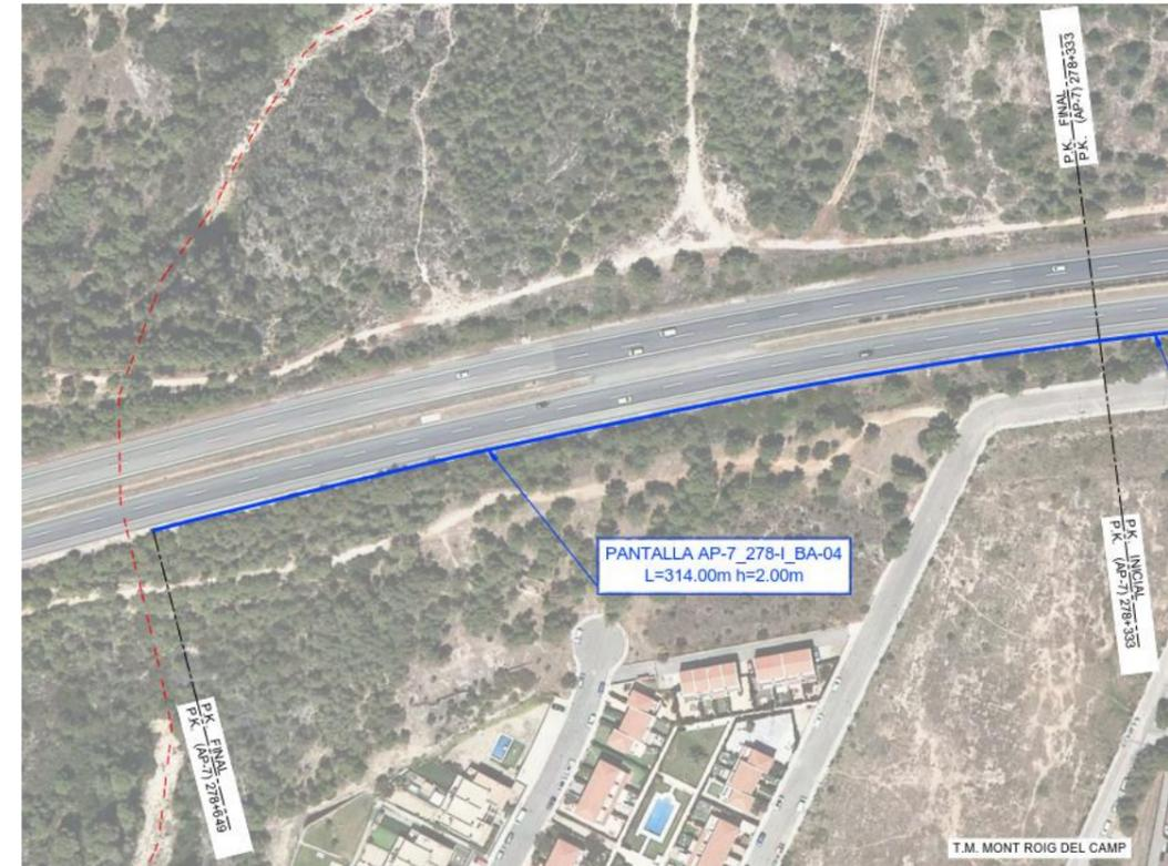
Figura 9. Posición de la pantalla con el terreno circundante.
