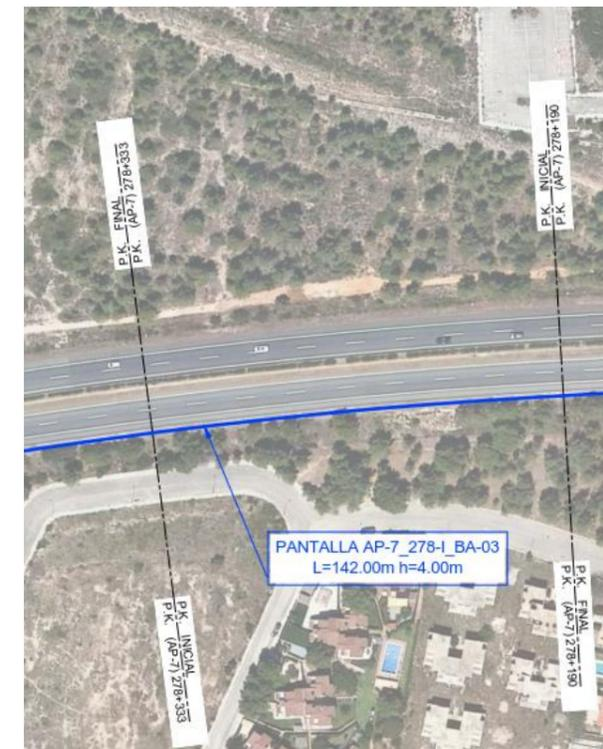
Figura 8. Posición de la pantalla con el terreno circundante.
