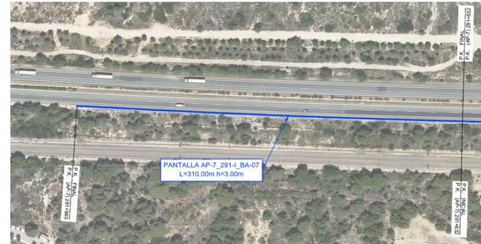
Figura 18. Posición de la pantalla con el terreno circundante.
