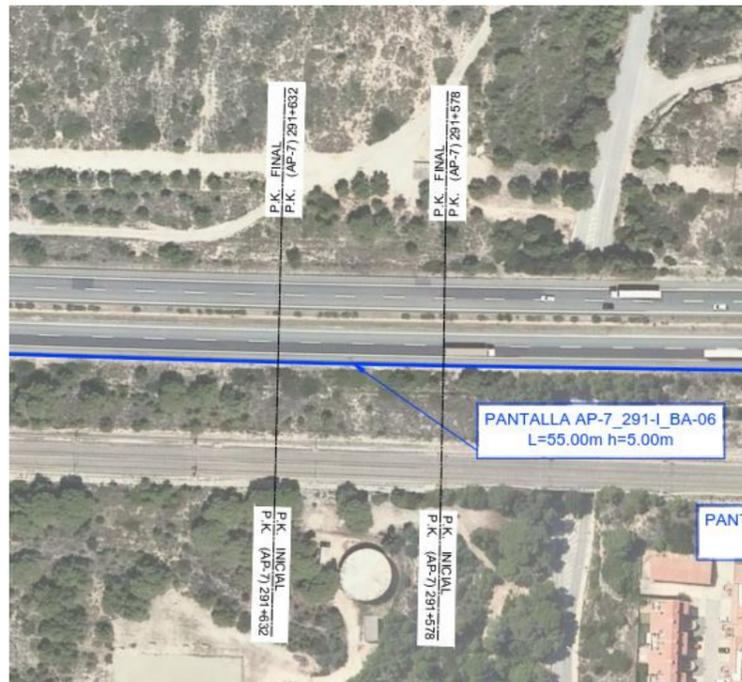
Figura 17. Posición de la pantalla con el terreno circundante.
