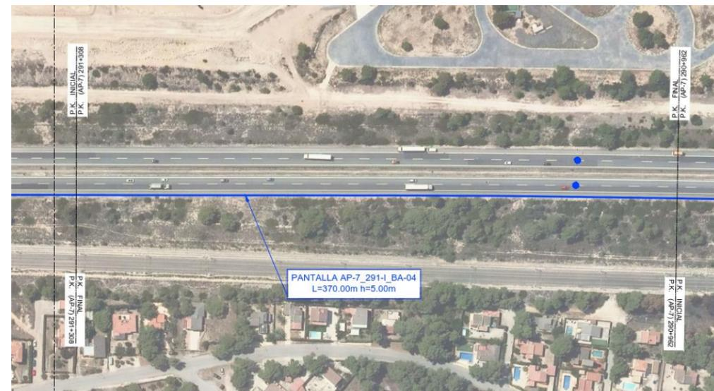
Figura 15. Posición de la pantalla con el terreno circundante.
