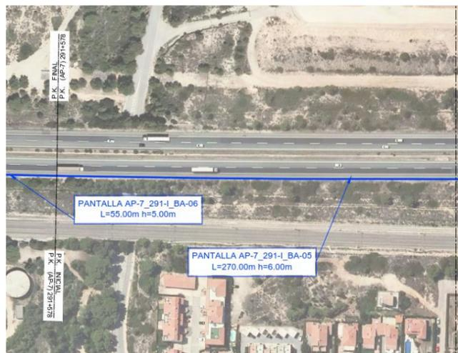
Figura 16. Posición de la pantalla con el terreno circundante.
