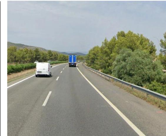
Se proyecta la sustitución de la barrera metálica con nivel de contención H2, anchura de trabajo W4, deflexión dinámica 0,9 m.
