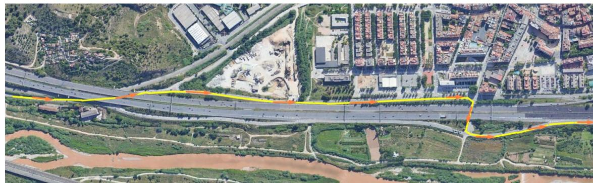
Con los movimientos afectados ya desviados, se procederá a construir toda la parte oeste del enlace, que incluye los ramales 1, 2 ,5 y 8, la reposición oeste de la carretera C-1413 y un tramo de la glorieta elevada con su conexión al viaducto sobre el río Llobregat.
