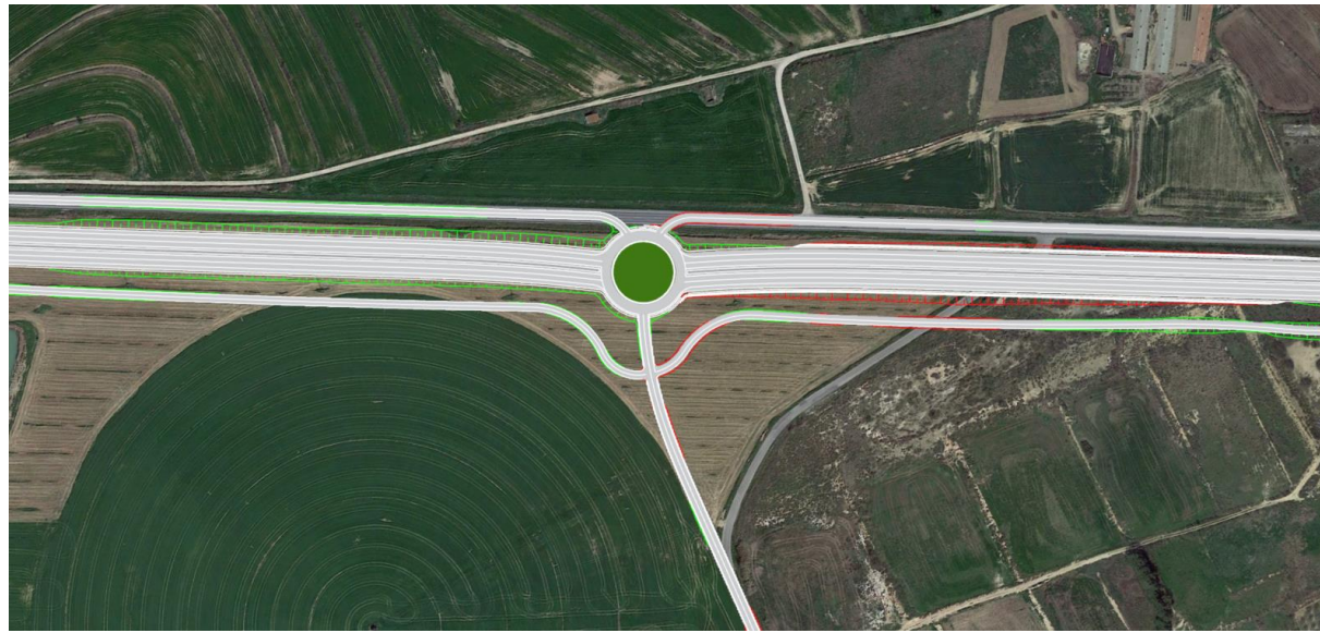
Figura 44. Glorieta de conexión con el camino del Tossal
