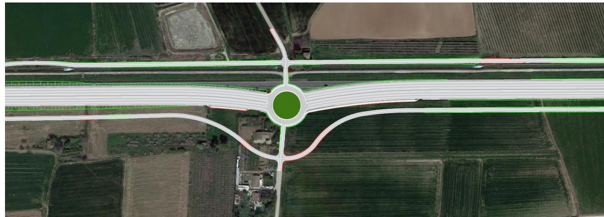
Figura 70. Glorieta de conexión con la carretera hacia Els Alamus
