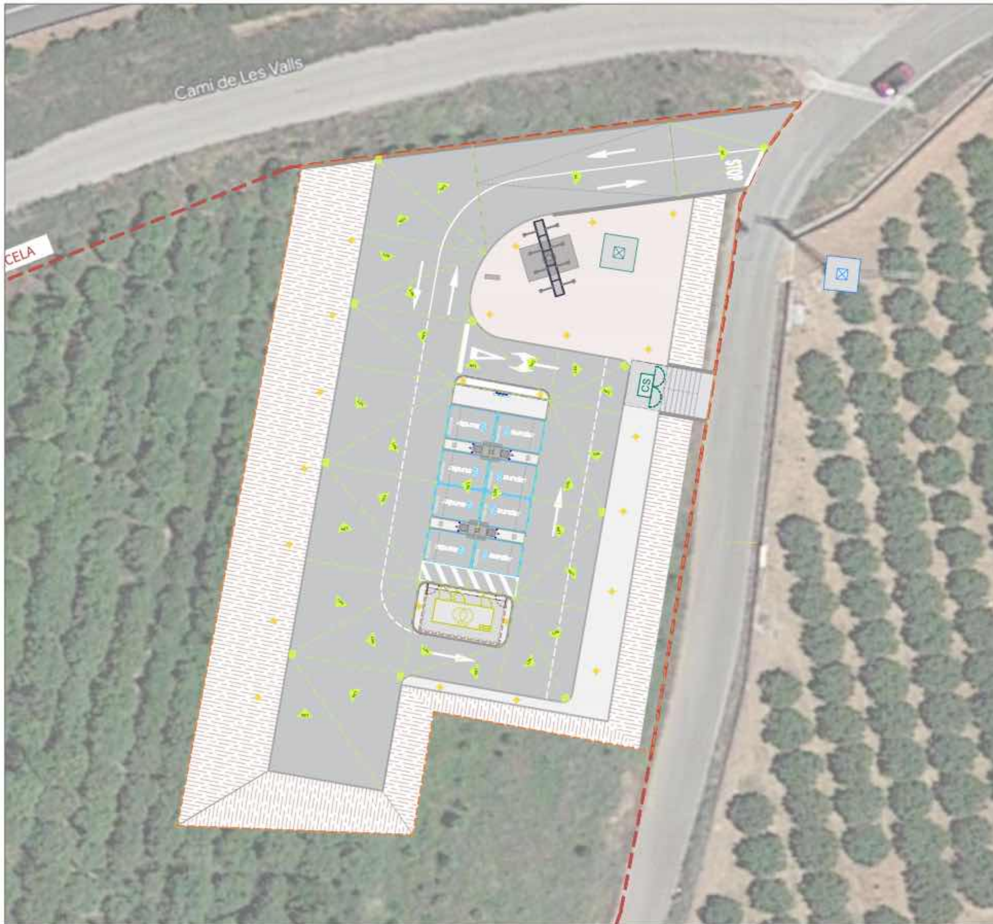
INSTALACIÓN DE PLUVIALES. PLANTA BAJA. CAIDAS. 1:400
