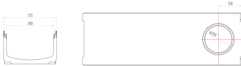
Imagen 35. Detalle de canaleta de drenaje en el viaducto del Guadalquivir.
