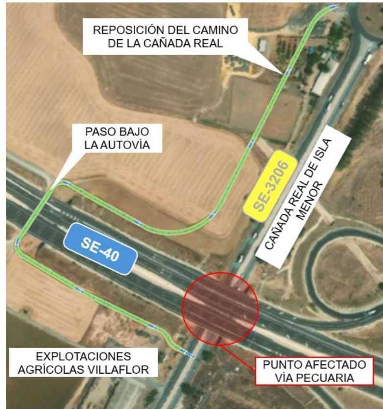
Imagen 91. Reposición de vía pecuaria por el paso inferior de la carretera SE-3206
