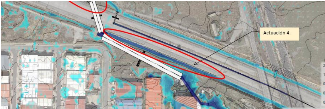
Fotografía 1.- Tramo de modificación de cuneta (entre pp.kk. 69+426 y 69+680)
